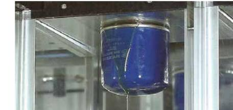
Рис. 3. Тест на герметичность показал – масло равномерно стекает
